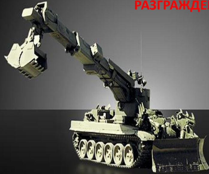
БРОНИРОВАННАЯ РЕМОНТНО-ЭВАКУАЦИОННАЯ МАШИНА ДЛЯ ЭВАКУАЦИИ АВАРИЙНЫХ ТАНКОВ И ОКАЗАНИИ ПОМОЩИ ПРИ РЕМОНТЕ БРЭМ-1М
